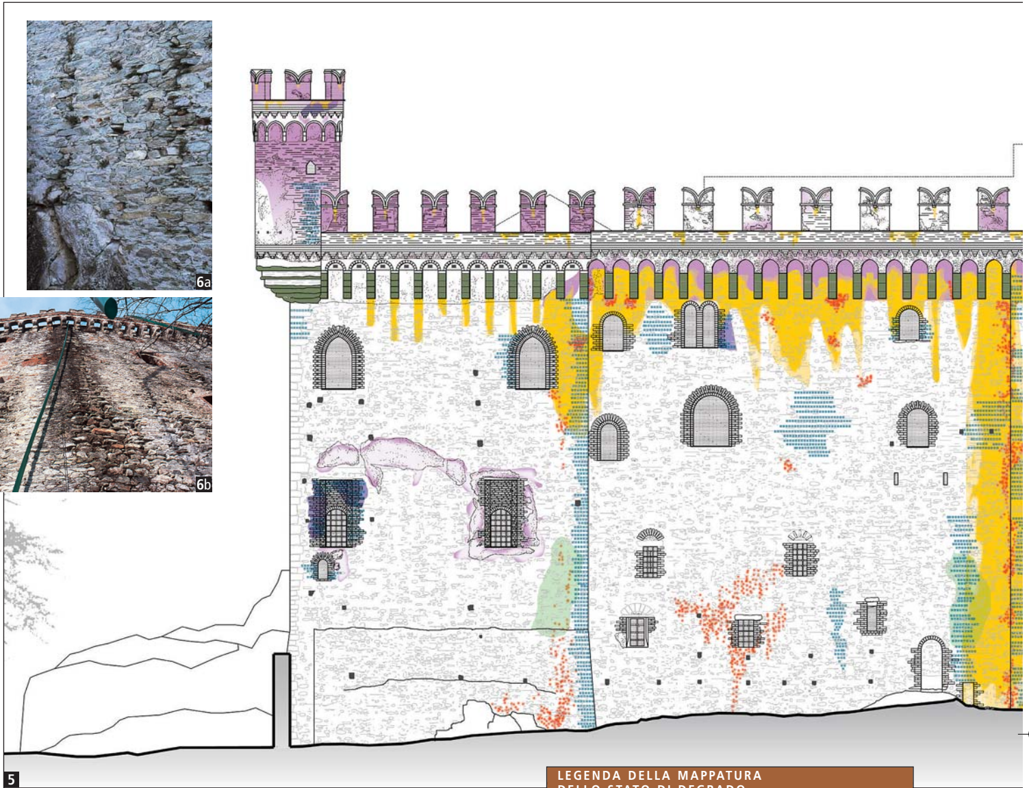
Figura 5 Estratto del progetto esecutivo. Prospetto sud, mappatura dello stato di degrado. Figure 6a-b Il fronte sud prima del restauro: particolari dei fenomeni di degrado presenti sul paramento lapideo.
